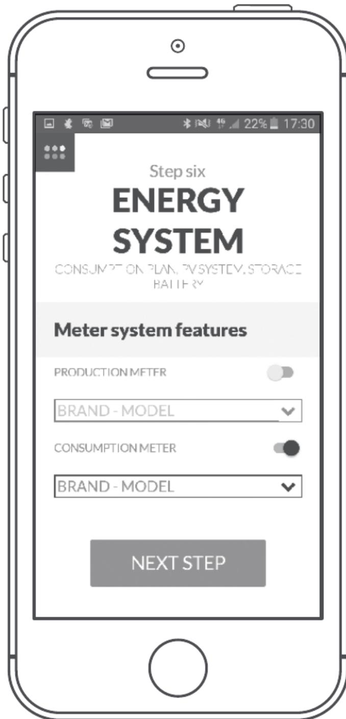
Figura 8 Schermata di configurazione dei due meter nell'applicazione mobile per l'installatore.
